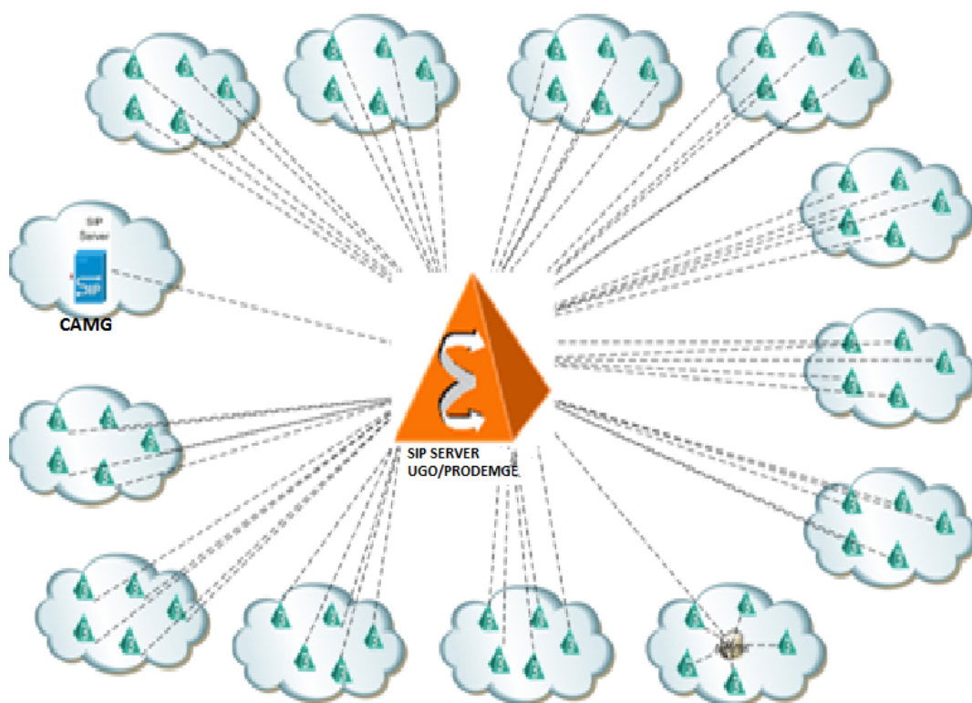
Figura 5 – Topologia Solução de VoIP Rede IP Multisserviços
